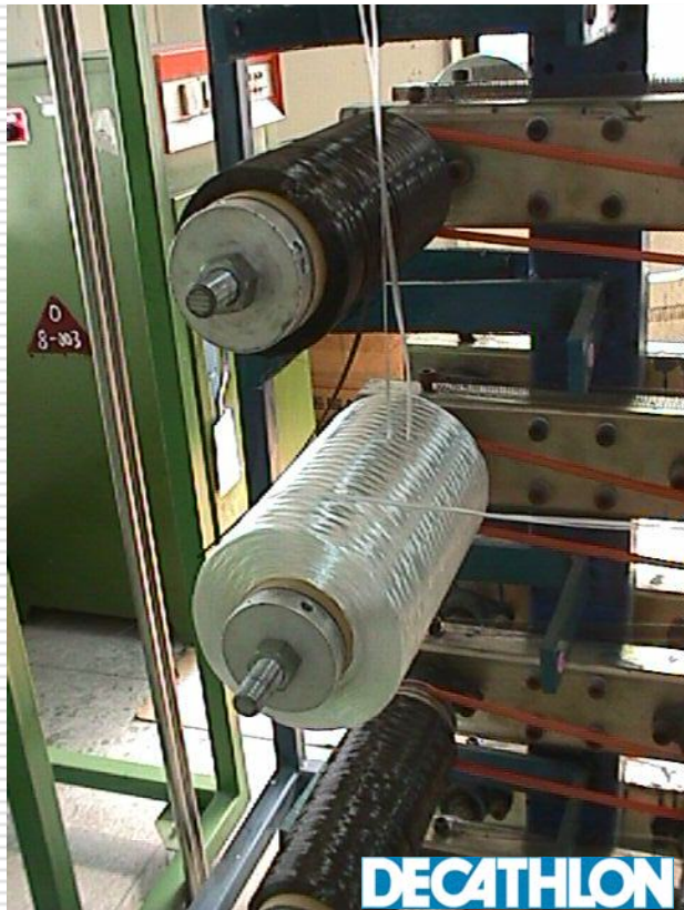
Matière première sous forme de bobines de fibres de verre ou de carbone
