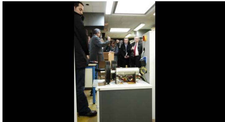
Au premier plan, les cylindres simulent l'ouverture des portes d'un train. Incroyable, non ?
