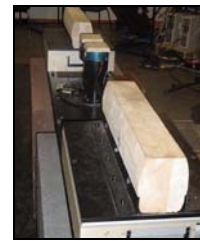
Figure n°1 : Instrumentation de la poutre avant aménagement des espaces libres.
