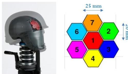
*Figure 1: Biokinetics Ballistic Load Sensing Headform instrumentés de 7 cellules d'effort piézoélectrique*
