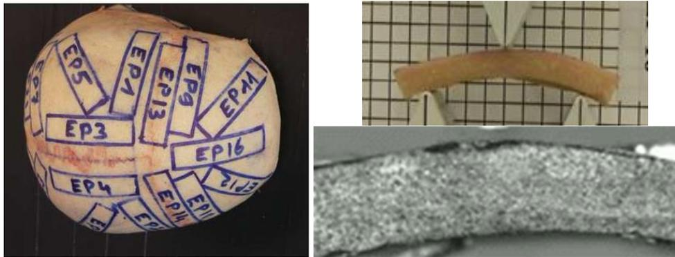
Figure 2: Exemple de cartographie de prélèvement d'éprouvettes et essais de flexion trois points.
