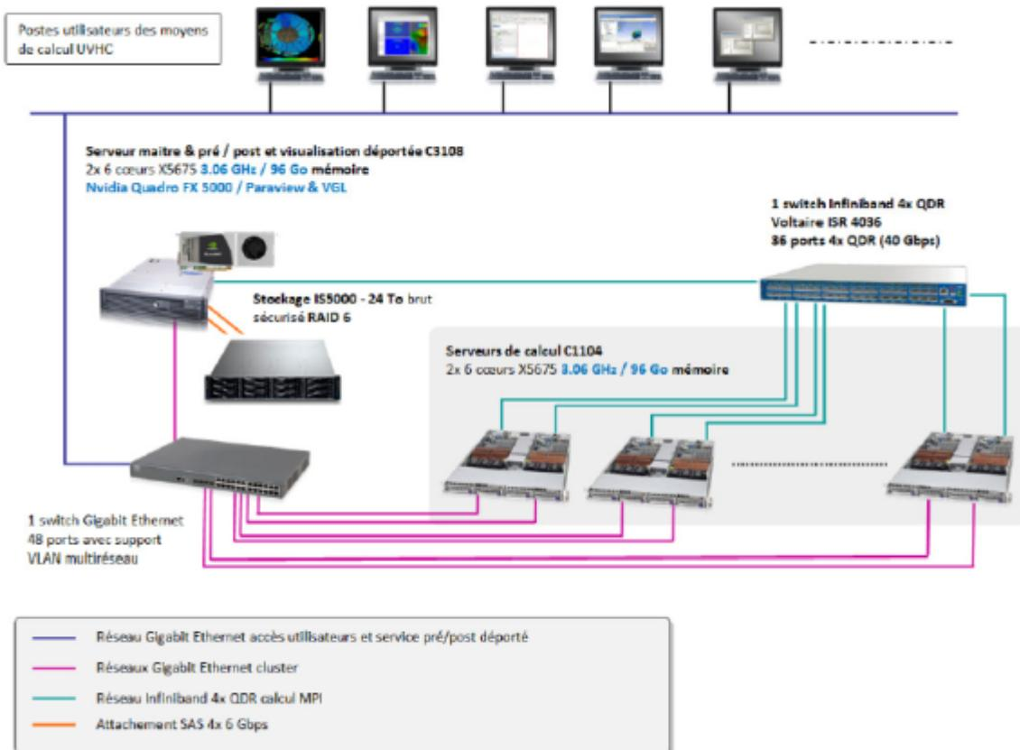
*Supercalculateur parallèle 300 coeurs Xeon 5675 3.06 GHz avec fonction de pré/post traitement et visu déportée*
